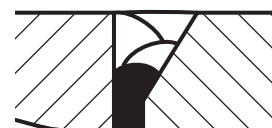
Figure 12. Construction d'un cordon de soudure
